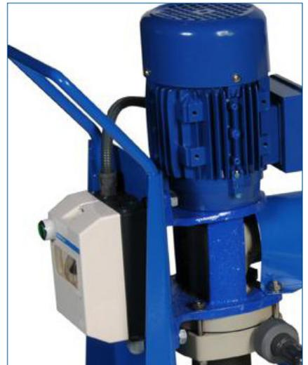
Diese Anlage ist für die schnelle Reinigung des Kühl- oder Heizungskreislaufes konzipiert, sowohl bei geöffnetem oder geschlossenem Kreislauf. Dieses Gerät ist fahrbar; es kann direkt an den Kreislauf des entkalkenden Gerätes angeschlossen werden. Es arbeitet mit einem Neutralisierungsprodukt aus Kalkstein.
