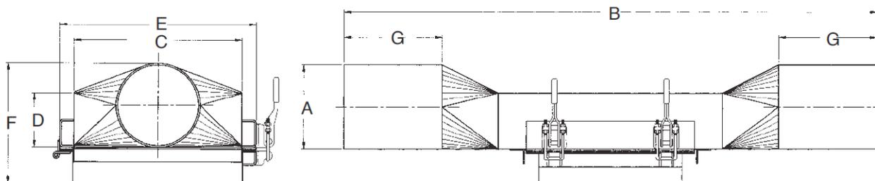
Les aimants en ligne pour transport par gravité ou pneumatique ont une architecture plein débit qui ne s'oppose pas au flux de produit. Les transitions coniques guident le matériau directement sur la face de l'aimant en plaque articulée, qui s'écarte du caisson pour un nettoyage extérieur rapide.
