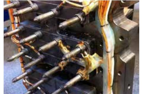
Le système AIRTECT alarme anti-fuite matière est un dispositif unique qui vous protège en permanence contre les fuites matières plastique, soit dans les systèmes à canaux chauds, soit au niveau des buses d'injections.
