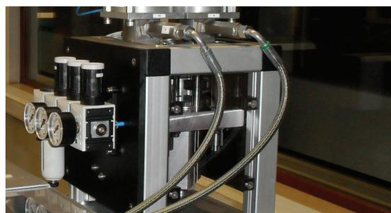
Nous avons développé un système de dosage pneumatique pour silicone liquide à 2 composants conditionné en fûts de 20 litres. Cette unité très peu encombrante est placée dans un châssis en aluminium, et est fixée sur la presse à injecter par l'intermédiaire d'une plaque d'adaptation.
