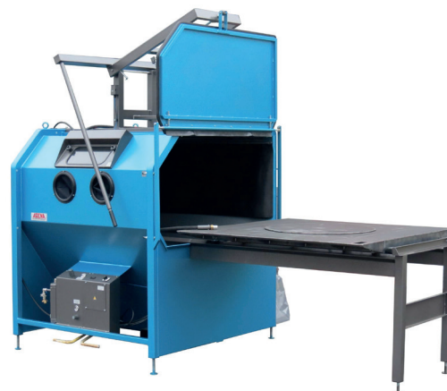
Cabine PF1515 avec chariot de chargement extérieur et porte guillotine
