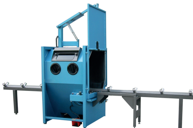
Cabine de projection à suppression pour le nettoyage de vos vis de plastification
