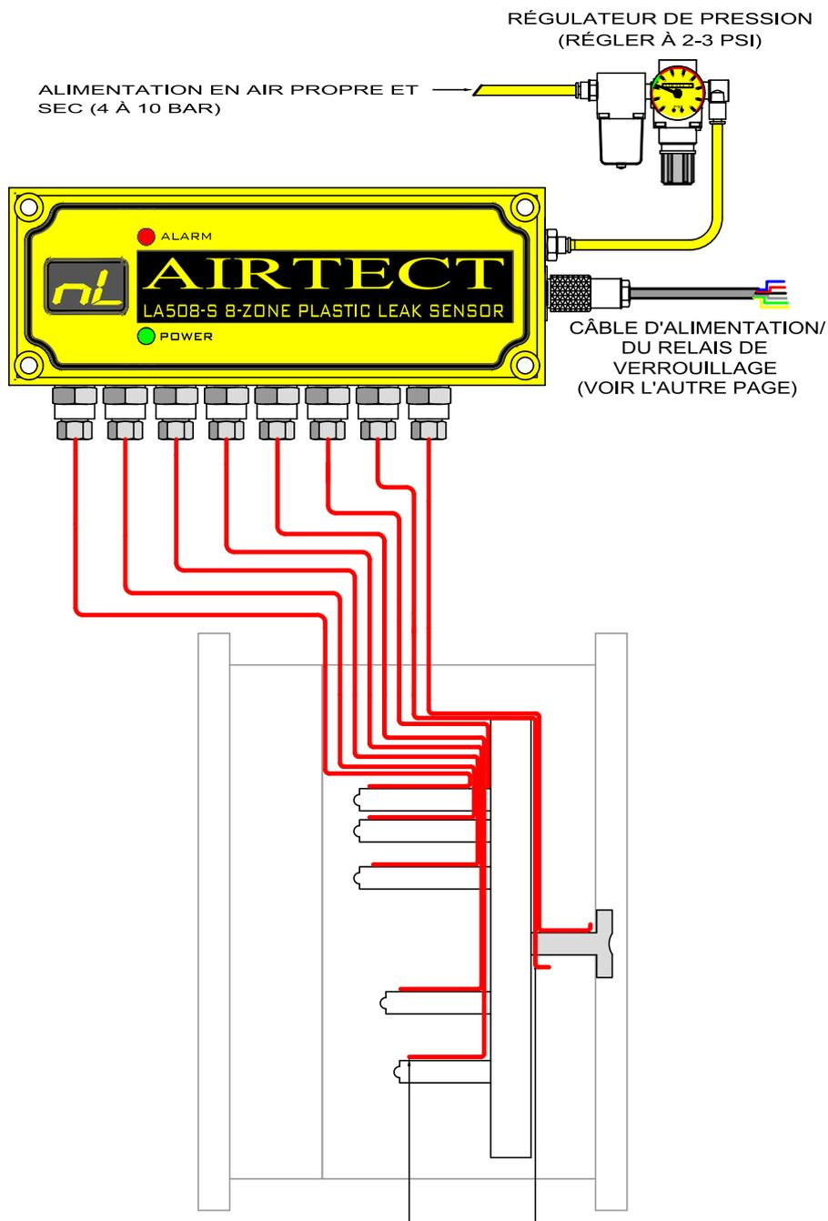
Installer le tubes de capteur aux endroits susceptibles de fuir.
