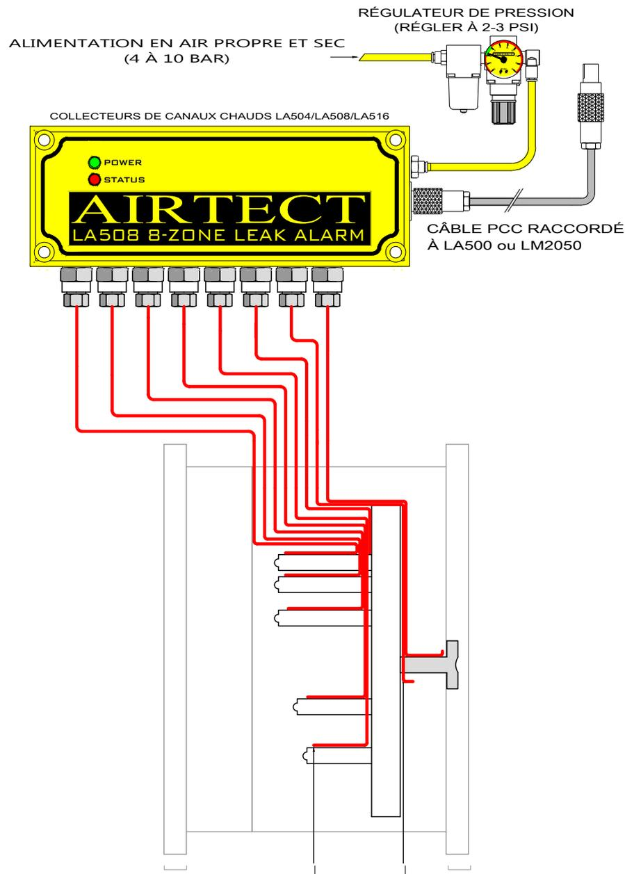
Installer le tubes de capteur aux endroits susceptibles de fuir.
