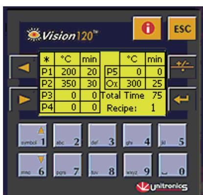
Lorsque le four n'est pas en cours de cycle, l'écran permet de selectionner un programme pour le cycle suivant. Presser la touche d'incrémentation montante (1) ou descendante (2) pour lister les programmes. Choisir un programme et basculer sur l'écran de suivi en appuyant sur la touche Enter.
