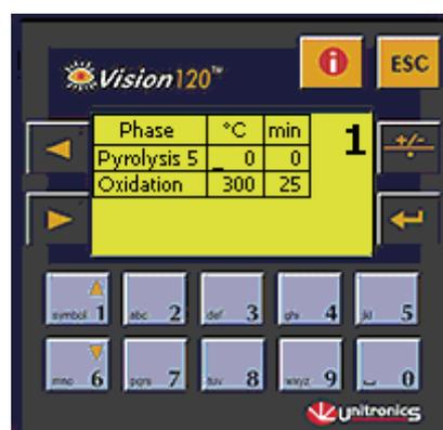
A la première mise en service le système est en mode programmation, l'index clignote devant le numéro du programme, utiliser le clavier numérique pour choisir un numéro et valider en appuyant sur la touche Enter.
