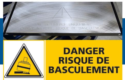
3. Installer les brides mécaniques à l'aide des tasseaux dans les rainures prévues à cet effet. **Attention la zone de bridage est prévue uniquement pour la fixation des équerres.**
