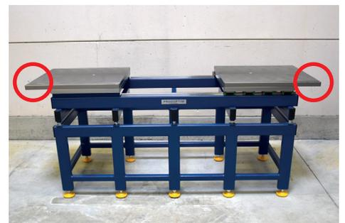
2. Faire pivoter les plateaux supérieurs à 180°C à l'aide des pivots, afin de présenter la zone de bridage vers l'extérieur.
