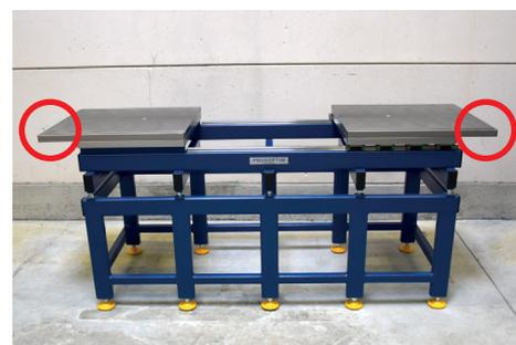
2. Faire pivoter les plateaux supérieurs à 180°C à l'aide des pivots, afin de présenter la zone de bridage vers l'extérieur.
