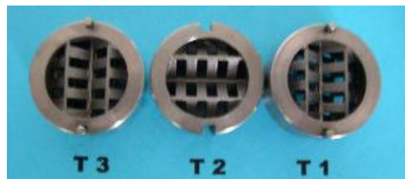
Figure 2 : Orientation relative à la grille de Mélange des slots et épingles
