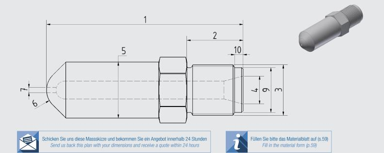
Alle Düsen sind mit poliertem Fliesskanal. Diese Massskitze gilt für alle unsere einteilige Düsen. Eine Liste der Maschinenhersteller finden Sie im letzten Abschnitt dieses Kataloges, insbesondere spezielle Düsen. Wir produzieren auch jede kundenspezifische Ausführung nach Zeichnung.
